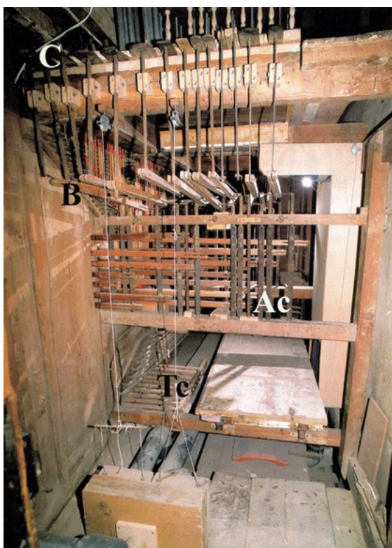
8. Interior de la caja del órgano en su parte de pedestal. Se observan las teclas de las contras (Tc), los árboles de compás (Ac) que transmiten la acción de los tiradores de los registros a los balancines (B) y estos, a las correderas (C); 9. Mecanismo de la reducción. Las teclas accionan las varillas verticales (V) que enganchan con los molinetes (M) para desplazar el efecto transmisor en la horizontal (fotos en Díez, M. A. y Acitores, F., 1996, p.45 y 49)
