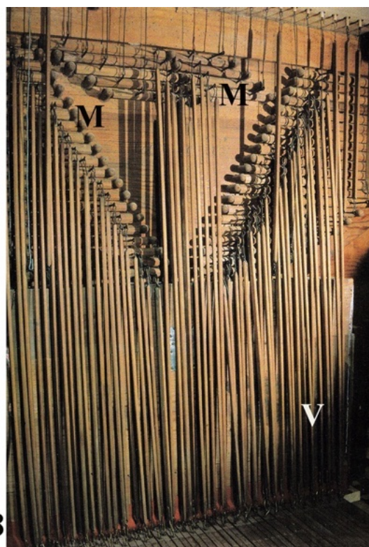
8. Interior de la caja del órgano en su parte de pedestal. Se observan las teclas de las contras (Tc), los árboles de compás (Ac) que transmiten la acción de los tiradores de los registros a los balancines (B) y estos, a las correderas (C); 9. Mecanismo de la reducción. Las teclas accionan las varillas verticales (V) que enganchan con los molinetes (M) para desplazar el efecto transmisor en la horizontal (fotos en Díez, M. A. y Acitores, F., 1996, p.45 y 49)
