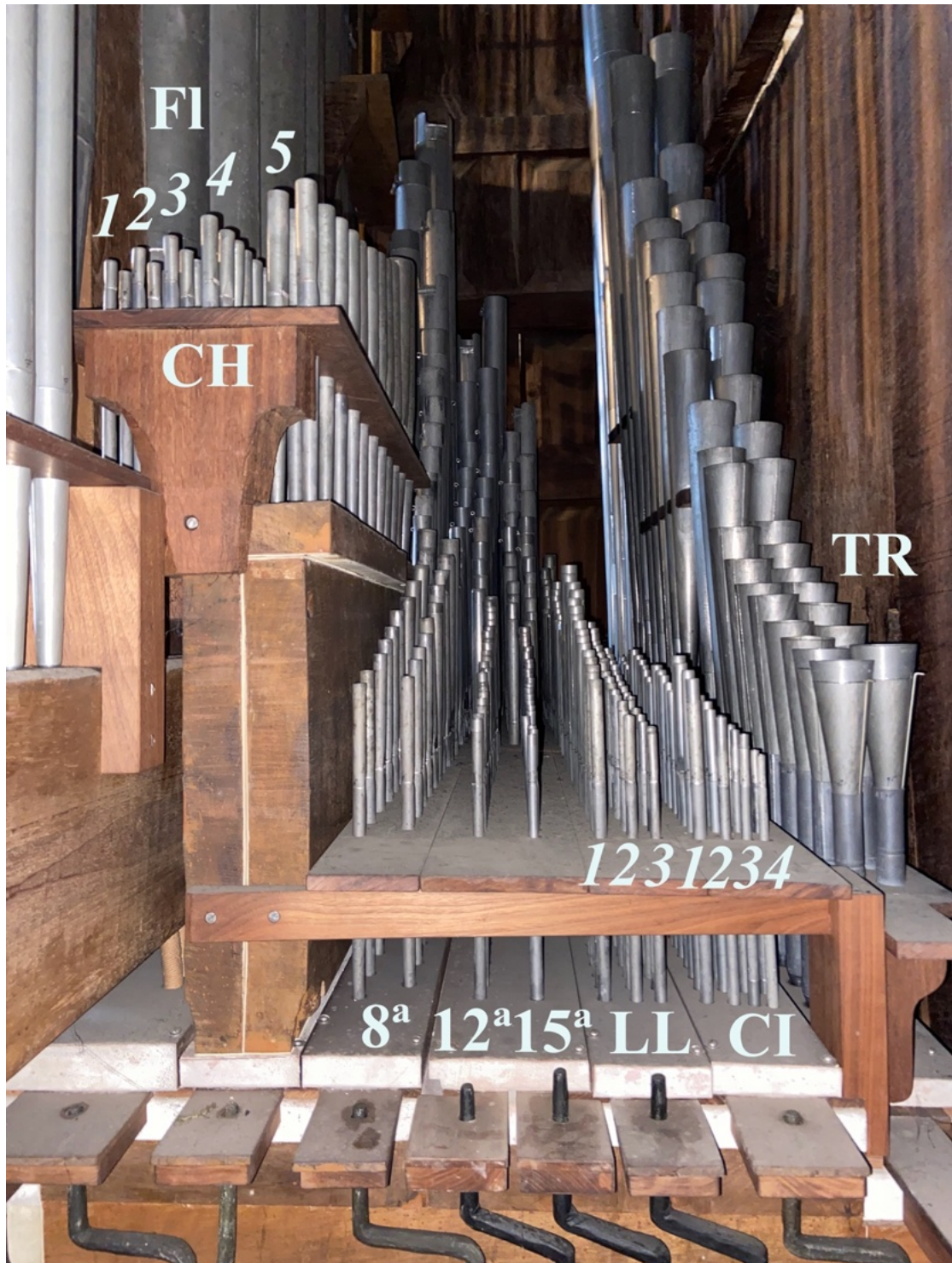
Detalle de los tubos del partido derecho en el interior de la caja del órgano. En un secretillo elevado, se aprecia la Corneta (CH) de cinco hileras (números en cursiva); por delante, el Flautado (FI) en fachada, y, por detrás, la Octava (8ª) en dos órdenes de tubos, la Docena (12ª) en uno, la Quincena (15ª) en uno, el Lleno (LL) de tres hileras (números en cursiva), la Címbala (CI) de cuatro hileras (números en cursiva) y la Trompeta Real (TR). En la parte inferior de la imagen se aprecian las correderas y la terminación de los árboles de compás
