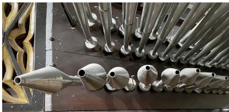
Detalle de los resonadores cónicos dobles del Fagot
